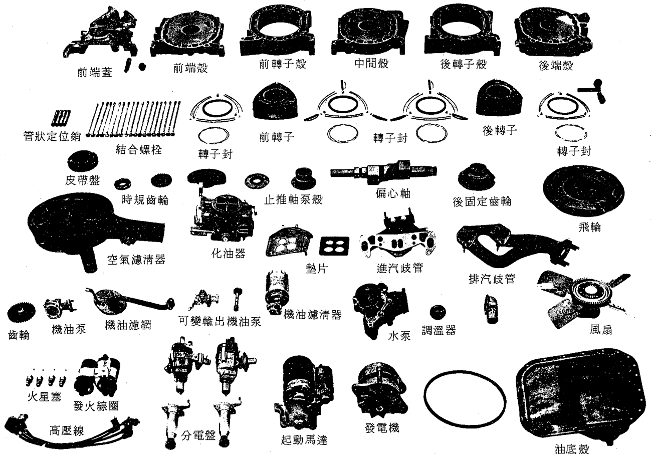
圖 2-11-1 迴轉活塞式引擎重要機件分解圖
