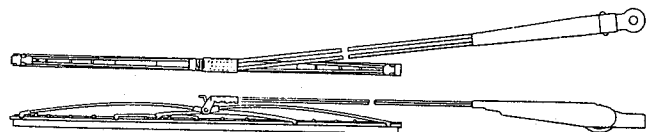
圖 5-10-26 曲面玻璃用鋼絲型雨刷臂及片〔註27〕
