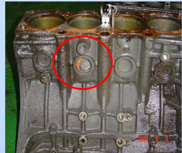
破壞完成之水套孔
